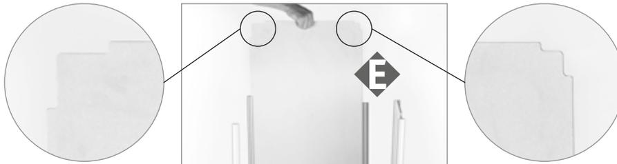
Schieben Sie nun die Rückwand (E) wie abgebildet zwischen die Stangen A und C.
